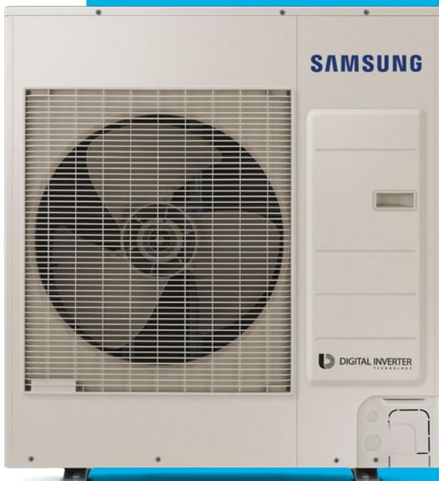
L'unité extérieure du système EHS Monobloc R32 fonctionne efficacement sur une large plage de températures ambiantes. Lorsque la température extérieure est supérieure à 10 °C, elle peut générer de l'eau chaude pouvant atteindre 65 °C. La production d'eau chaude d'une température de 40 °C est garantie, même lorsque la température extérieure est inférieure à -25 °C. Le système est ainsi extrêmement flexible et peut être installé dans des climats très variés.
