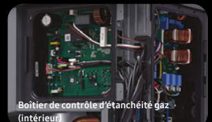
Les **sources d'explosion** potentielles sont **isolées** hermétiquement et placées au plus haut niveau de l'unité extérieure.
