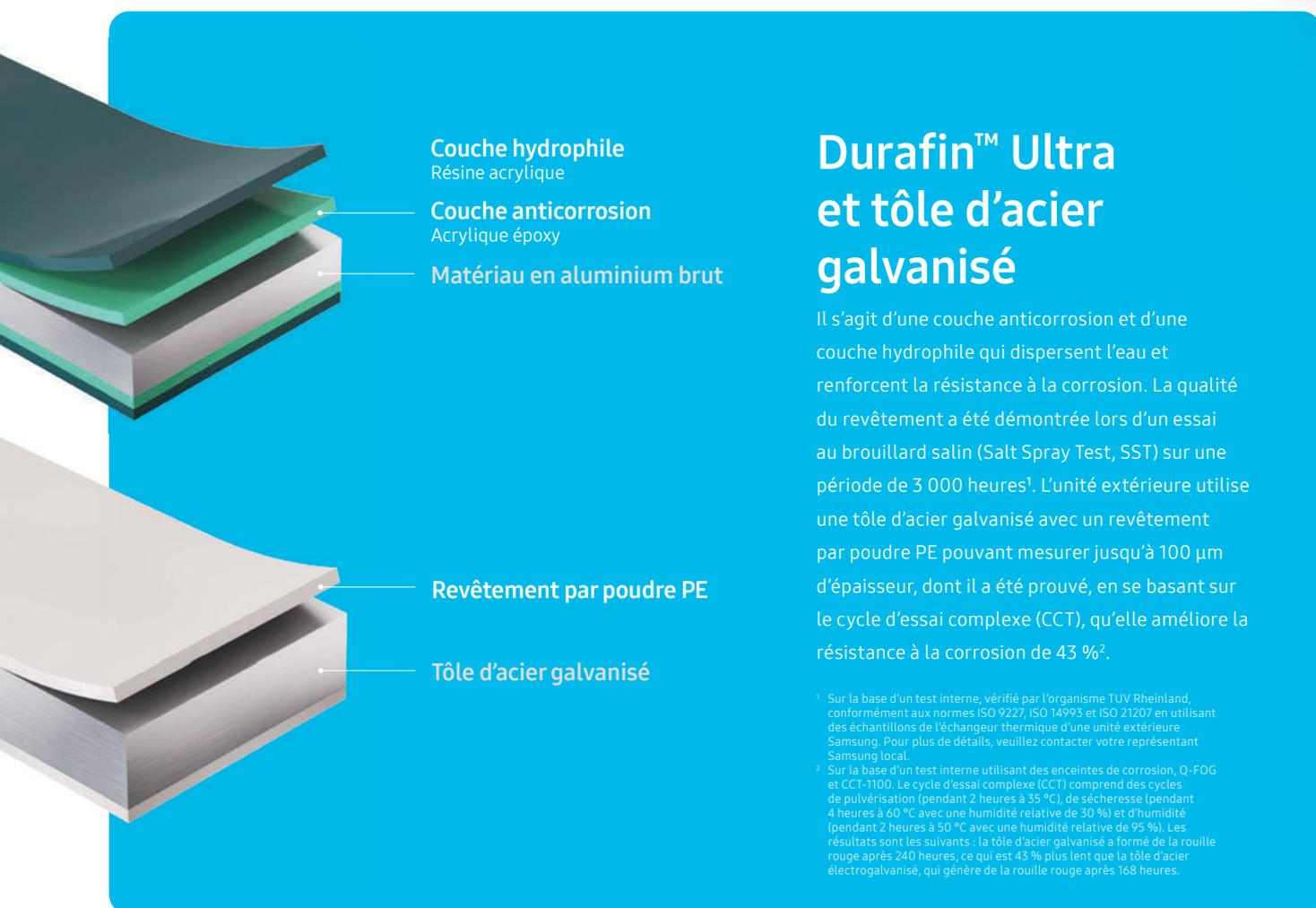
Le diagramme illustre la structure de protection anticorrosion de l'unité extérieure. Il est divisé en deux sections : la partie supérieure (à gauche) montre les couches de revêtement appliquées sur un matériau en aluminium brut, et la partie inférieure (à droite) montre la structure de la tôle d'acier galvanisé avec un revêtement par poudre PE.
