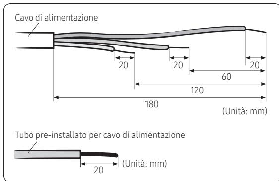
**3** Inserire entrambi i lati del filo centrale del cavo di alimentazione nel manicotto di connessione.
