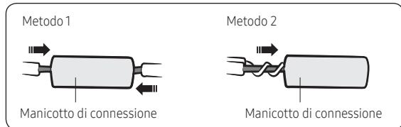
**4** Utilizzando una crimpatrice, comprimere i due punti, quindi capovolgerlo e comprimere altri due punti nella stessa posizione.
