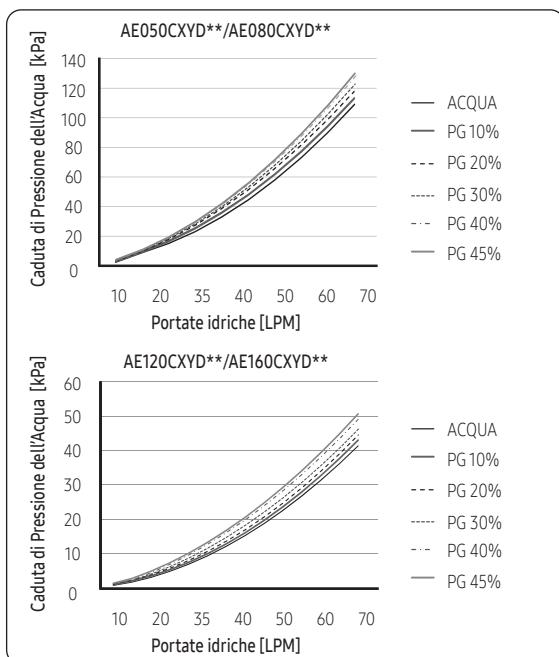
Cambiando la concentrazione di glicole è possibile ridurre la pressione del sistema, il che può a sua volta comportare un notevole rallentamento della portata.
